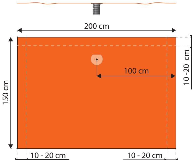
**Sealing membrane** | Dichtvlies | Waterdicht doek | Tætningsduk | Vanntett duk | Membrana impermeable | Tela impermeabilizadora | Telo impermeabile | Tissu étanche | Wodoszczelne płótno
